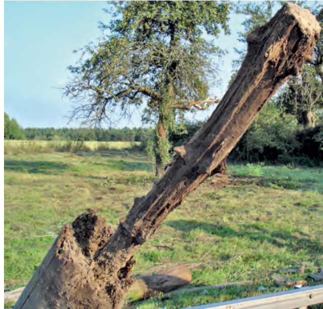
Zehn Jahre alter Pfahl: Wie lange ein Pfosten stabil bleibt, hängt von Holzart und Boden ab.
