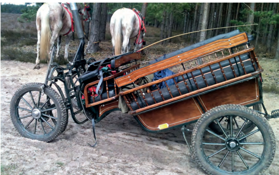
Bei der Kutsche ist der Rahmen gebrochen. Sie wurde in Polen gefertigt – doch leider wurden keine Knotenbleche eingeschweißt. Der Bruch passierte auf einer Ausfahrt. Foto: Wewetzer
