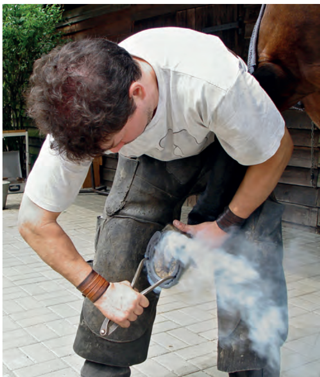
Nicht unumstritten: das beim Eisenbeschlag erforderliche Aufbrennen nach der Hufbearbeitung. Foto: Fersing
