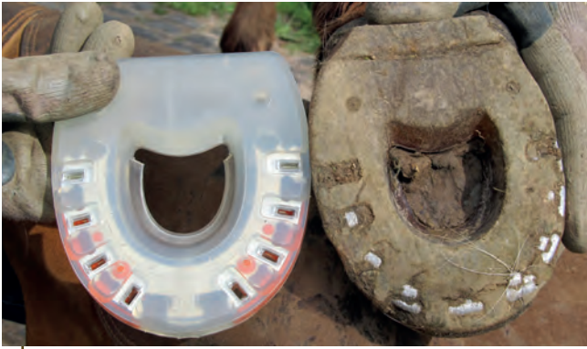
Neu und nach 600 Kilometern: Kunststoffbeschlge halten mittlerweile ebenso lange wie oder sogar lnger als Eisen. Foto: Pilartz
